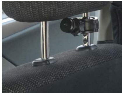
今度は前向きシート用に使ってみます。ヘッドレストは柱の下側プラスチックの横がボタンになっていて、押しながら上げると取れました
